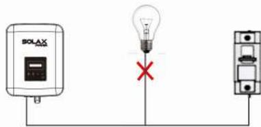
Conexión Incorrecta entre Carga e Inversor
