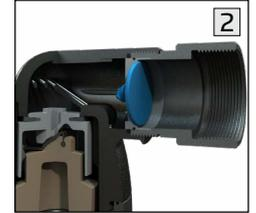
2 Prevención de entrada de aire (código C10-IP), solamente para entradas de 2-3"; DN50-80
