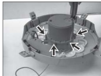
2. Utilice un destornillador para quitar todos los tornillos de la cubierta que protege la batería.
