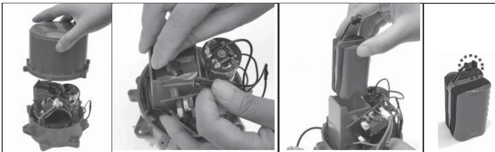
3. Abra la tapa de la batería, busque la línea de conexión de la batería, presione el clip del conector, tire y retire la batería.
