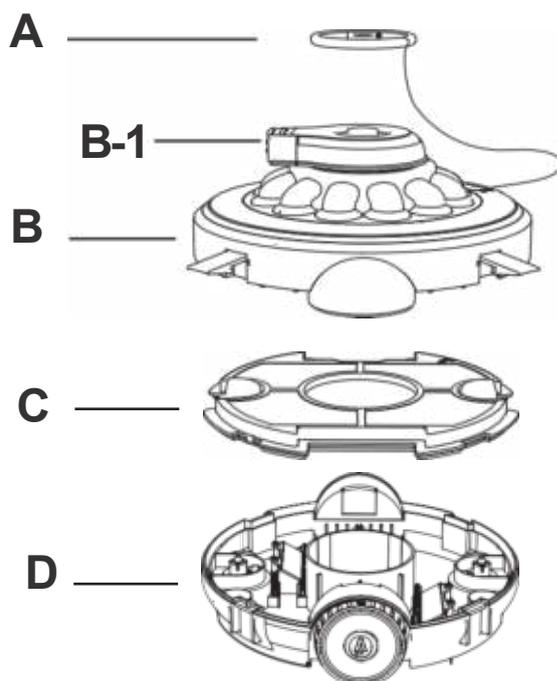
Hay un cabezal de propulsión de chorro giratorio en la cubierta superior, el agua pasa desde la parte inferior al cabezal de propulsión de chorro de agua para garantizar el movimiento del robot.
