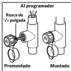
3. Atornille la caja del soporte SmartPort al adaptador en forma de "T", tal y como se muestra.
