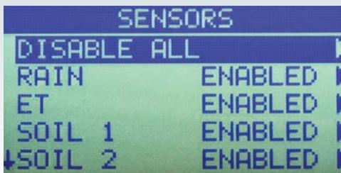
Por ejemplo, la pantalla **Aplicar sensores** permite ver y configurar fácilmente todos los sensores disponibles en el programador, incluyendo lluvia, ET y suelo.
