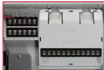
Configuración de 16 estaciones con 1 módulo de 12 estaciones
