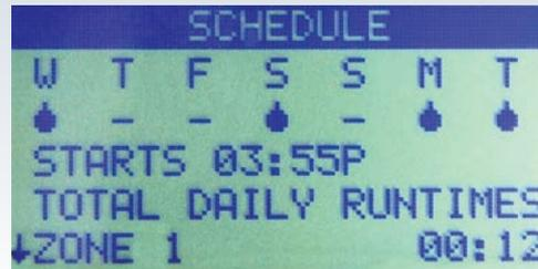
Otro ejemplo es la pantalla de **Revisión**, un resumen rápido que muestra los días de riego programados para los próximos siete días para la hora de riego seleccionada.
