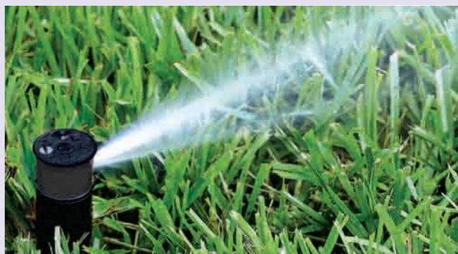
MiniPro es un aspersor de turbina, capaz de regar una zona entre 5,1 a 9,1 metros de radio, y a una presión en la boquilla de 2,1 a 3,4 bares con un caudal de 2,84 a 12,5 L/M. El MiniPro se suministra con cinco (5) boquillas intercambiables y codificadas numéricamente. La trayectoria de la boquilla es de 26°. El aspersor dispone de un tornillo de ajuste del chorro en acero inoxidable.
