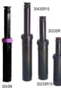
Gama de difusores emergentes de tamaño reducido disponibles en tres formatos según emergencia del émbolo, 5 cm, 7,5 cm ó 10 cm. Modelos montados con tobera regulable SR-3599 de facil regulación, no necesita llave. La tobera se puede separar del cuerpo facilita la limpieza y reposición de la tobera. Provisto de carraca, junta autolimpiante y disponible para aguas recicladas. Conexión 1/2" H. Ø del cuerpo 32,5 mm.
