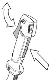
Consulte las instrucciones bajo el título Arranque. Ponga en marcha la máquina y acelere al máximo. Suelte el acelerador y controle que el equipo de corte se detenga y permanezca inmóvil. Si el equipo de corte gira con el acelerador en ralentí, se debe controlar la regulación del carburador para ralentí. Consulte las instrucciones bajo el título Mantenimiento.
